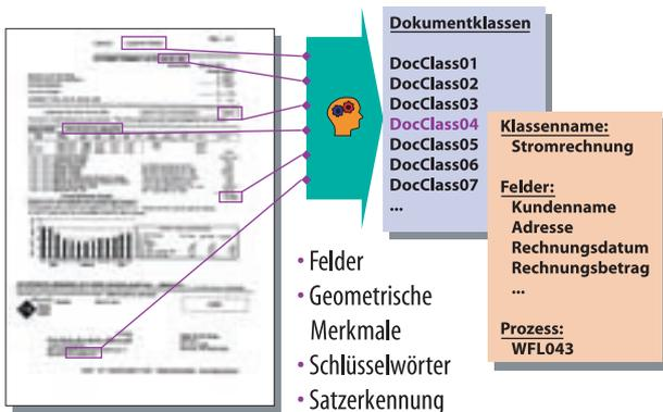
Die Klassifikation wendet Regeln an, die beim Training mit einer bestimmten Anzahl an Dokumenten für jede Klasse gelernt werden. Mit Hilfe dieser Beispiele lernt der Klassifikationsprozess die Regeln selbst.
