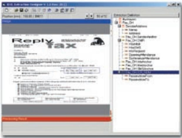
Wurde das gescannte Dokument als ein bestimmtes Dokument klassifiziert, setzt das Template einen Prozess in Gang, der die relevanten Felder aus dem Dokument basierend auf Datendefinition im Template extrahiert.
