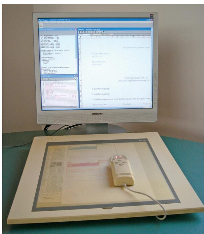
*Consente di utilizzare un digitalizzatore di tipo CAD per accelerare la generazione di form esistenti con AFP Designer.*
